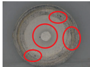
尘埃附着在接点表面， 造成接触不良
