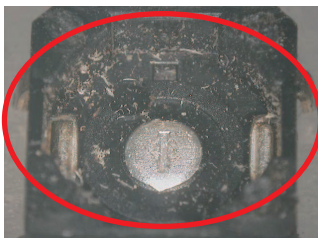
尘埃从操作杆与盖板的 间隙进入
