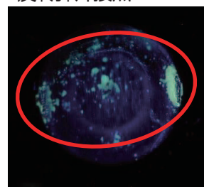
助焊剂附着在接点表面，造成接触不良
