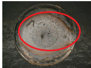
尘埃附着在接点表面， 造成接触不良
