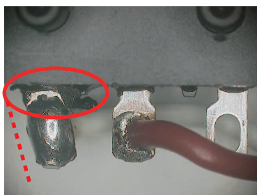
端子根部的树脂熔化， 端子歪倒
