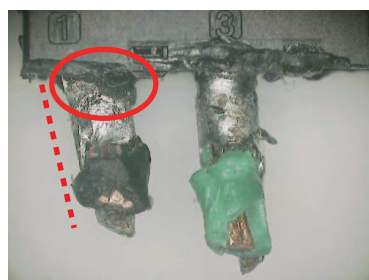
端子根部的树脂熔化， 端子歪倒
