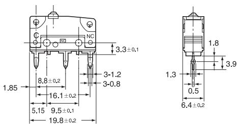
&lt;印刷基板用端子孔加工图 (参考) &gt;
